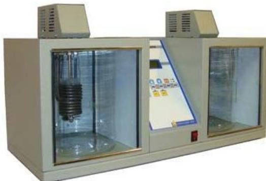
ویسکومتر برای روغن های شفاف cannun- ublholde و برای قیر مواد غیرشفاف از ویسکومتر های معکوس – rivers arm crass و برای قیر از ویسکومتر های u-t استفاده می شود .
