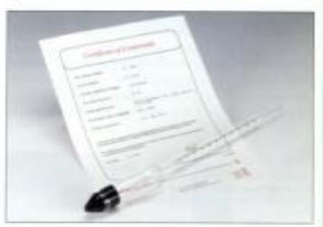
تجهیزات وزن مخصوص بر اساس ASTM D 287
