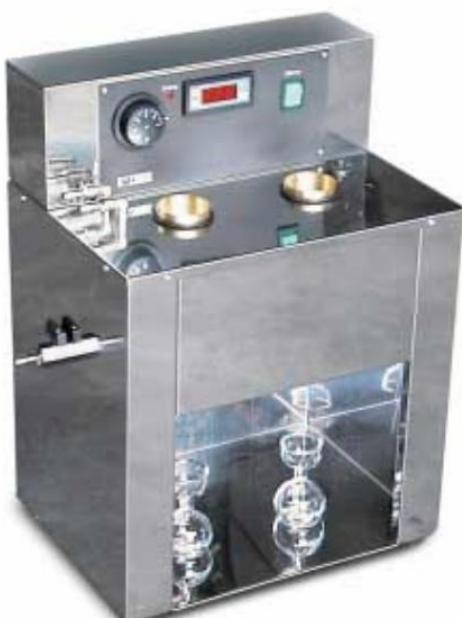
آزمایش ویسکوزیته قیر به روش ردود از ویسکومتر ردود برای تعیین کندروانی قیرهای مایع استفاده می شود . از آنجایی که قطر سوراخ این ویسکومتر کوچک است ، لذا قیرهای خالص و حتی قیرهای مخلوط به کندي از آن عبور کرده و مدت زمان زیادی نیاز دارند . از این ویسکومتر در اندازه گیری کندروانی قیرهایی که همراه با حلال هایی چون کروزین ، گازوئیل و گازولین که در تهیه قیرهای مخلوط به کار می روند ، استفاده می شود . می توان برای یافتن مطالب بیشتر به استانداردهای زیر مراجعه نمود :
