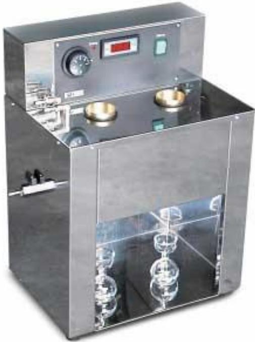
بدنه دستگاه از جنس استنلس استیل ضد زنگ و ضد اسید ساخته شده است . همچنین دارای دو روزنه فیورل و معمولی همراه با هیتر برقی ، ترمومتر و ترموستات دیجیتال ، همزن و کوپل خنک کننده می باشد .
