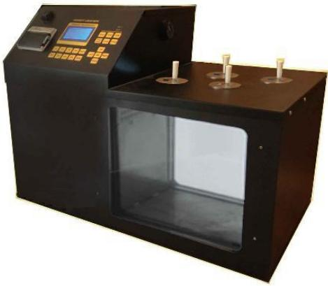
آزمایش ویسکوزیته قیر به روش کینماتیکی در روش اندازه گیری کنروانی به روش کینماتیکی ، با عبور مقدار ۵۰ میلی لیتر قیر مورد آزمایش با درجه حرارت ۴۰ درجه سانتیگراد از مجرای لوله استاندارد دستگاه زمانی که صرف عبور قیر شده است را یادداشت می کنیم و این زمان را به عنوان کنروانی قیر محسوب می نماییم .
