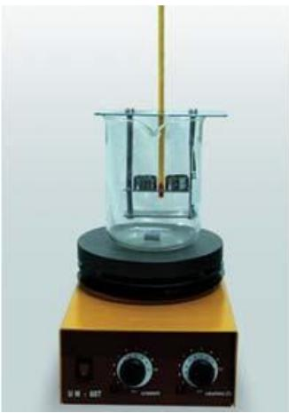
نقطه نرمی قیر عبارت است از درجه حرارتی که در آن قیر حالت نرمی پیدا می کند . به طور کلی می توان گفت که همه قیرها در این درجه حرارت به یک گرمازوی مشخص می رستند . نقطه نرمی قیر به روش های مختلف اندازه گیری می شود که یکی از این روش ها ، روشنی به نام حلقه و گلوله است که در آن نقطه نرمی را درجه حرارتی که در آن گلوله ها از حلقه عبور نموده و به سطح برنجی تحتانی به فاصله ۲۵ میلی متری برسد ، تعريف می کند .
