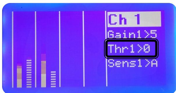
در صورت نیاز و وجود نویز بالا در سایر کانالها با قرار گرفتن بر روی گزینه CH و استفاده از کلید های {◀}{▶} دیموت به کانالهای بعدی (فته به روشن فوق عمل کنید .
