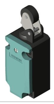
SIRIUS POSITION SWITCH METAL ENCLOSURE 40MM ACC. TO EN50041 DEVICE CONNECTION 1X (M20X1.5) 1NO/1NC SNAP-ACTION CONTACTS METAL ROLLER LEVER AND PLASTIC ROLLER 22MM
