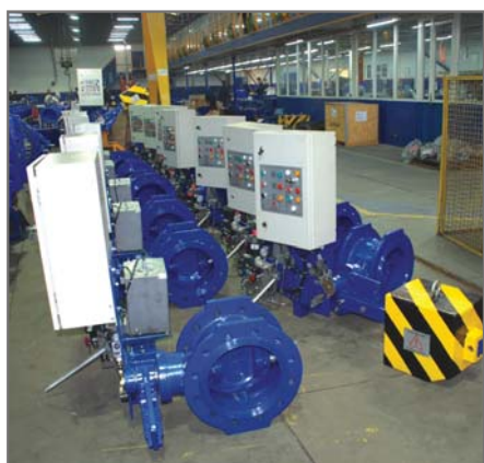
شیرهای سایز 300 و 350 فشار 16 بار - نرمال باز کاربرد: شکستگی خط پروژه: آبرسانی روستایی زهک آب و فاضلاب سیستان و بلوچستان
