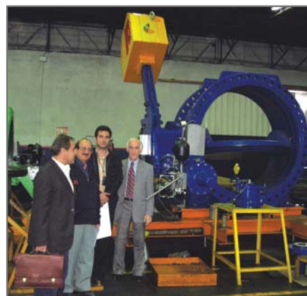
شیر سایز 1800 فشار 25 بار - نرمال باز کاربرد: شکستگی خط پروژه: سد آیدوغموش آذربایجان شرقی
