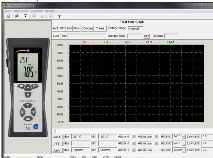
Falls das Messgerät nicht erkannt wird, stellen Sie sicher, dass der korrekte COM-Port ausgewählt ist. Diesen können Sie im Geräte-Manager sehen (Systemsteuerung -> GeräteManager):
