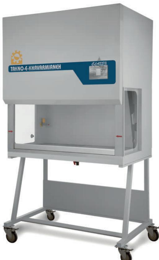
در مدل تیپ (A) دو سوم از هواي داخل کابین به طور ثابت به گرددش در می آيد و يك سوم نيز پس از فیلتره شدن به محیط بر می گردد ضمن آنکه فیلتر اصلی نیز به پیش فیلتر مجهز می باشد.
