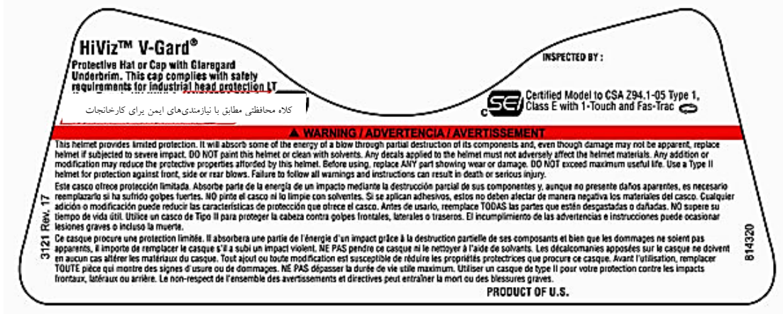
شکل ۳-۲۱ برچسب مشخصات کلاه ایمنی
