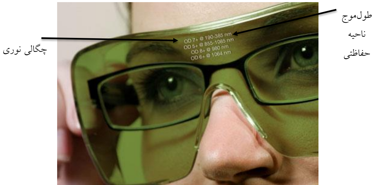
شکل ۳-۱۶ نحوه برچسب گذاری بر روی عینک ایمنی مورد استفاده برای کار با لیزر
