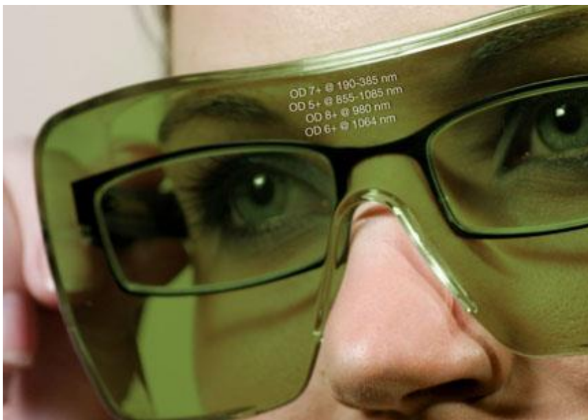
شکل ۱۲-۳ کاربرد عینک ایمنی لیزر به همراه عینک طبی
