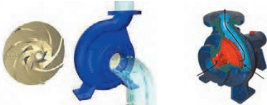
شکل ۵-۳ مسیر حرکت سیال در پمپ گریز از مرکز
