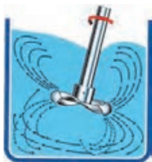
شکل ۲۷-۳ قرار دادن همزن خازج از مرکز و افزایش آشفته‌گی
