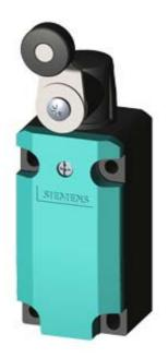
SIRIUS POSITION SWITCH METAL HOUSING 40MM TO EN50041 DEVICE CONNECTION 1X (M20X1,5) 1NO/ 1NC SNAP-ACTION CONTACTS ROTARY ACTUATOR RIGHT/LEFT ADJUSTABLE, METAL LEVER 27MM LONG AND PLASTIC ROLLER 19MM
