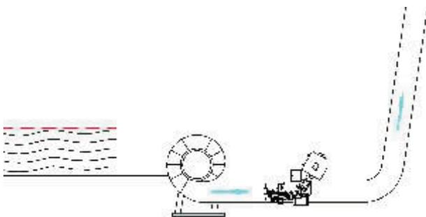
از این شیر بعنوان شیر چند منظوره ( ایزوله، یکطرفه و کنترل پمپ) استفاده میشود و وظیفه حفاظت از الکتروموتور و پمپ را به عهده دارد و تضمین کننده شروع حرکت آرام موتور و پمپ بوده و در موقع خاموش شدن پمپ و یا قطع اضطراری برق به عنوان شیر یکطرفه با بسته شدن آرام از ایجاد ضربه قوچ جلوگیری میکند و در موقع سرویس و تعمیرات، بعنوان شیر ایزوله عمل میکند. همچنین از این شیر بعنوان شیر قطع اضطراری سریع جهت جلوگیری از برگشت آب به ایستگاه پمپاژ در هنگام ایجاد شکستگی در ایستگاه پمپاژ استفاده نمود.
