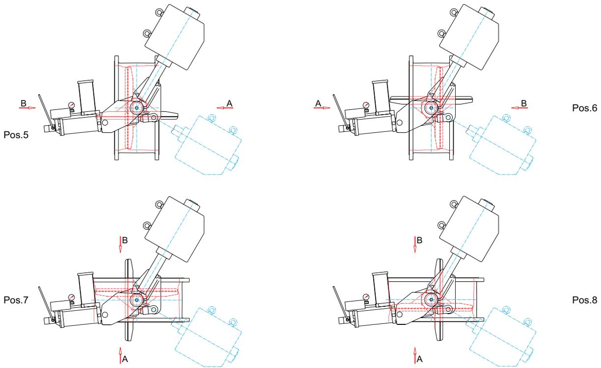
تذکر: A = ناحیه پر فشار (سمت توصیه شده به منظور آببندی بهتر، مخصوصاً برای سایزهای DN1000 به بالا و فشار بالاتر از 16 bar)
