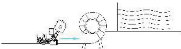
این شیر در مسیر آب ورودی توربین قرار می‌گیرد و به عنوان شیر ایمنی در مواردی که توربین سریعاً باید متوقف گردد استفاده می‌شود. در موارد زیادی این شیر به عنوان بای پاس (گذر جانبی) به منظور سنکرون کردن سرعت توربین بکار میرود و در موقع سرویس و تعمیرات، بعنوان شیر ایزوله عمل میکند.
