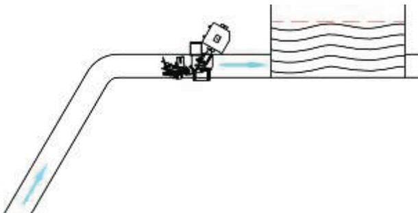
این شیر با دریافت فرمان از یک حس کننده سطح آب مخزن می‌تواند در ورودی مخازن نصب و سطح آب مخزن را کنترل نماید، در عین حال در صورت شکستگی لوله در مسیر ورودی مخزن جریان سیال را متوقف و از برگشت و هدر رفتن آب مخزن و خرابی ناشی از جاری شدن ناخواسته آب مخزن جلوگیری نماید و در موقع سرویس و تعمیرات، بعنوان شیر ایزوله عمل میکند.
