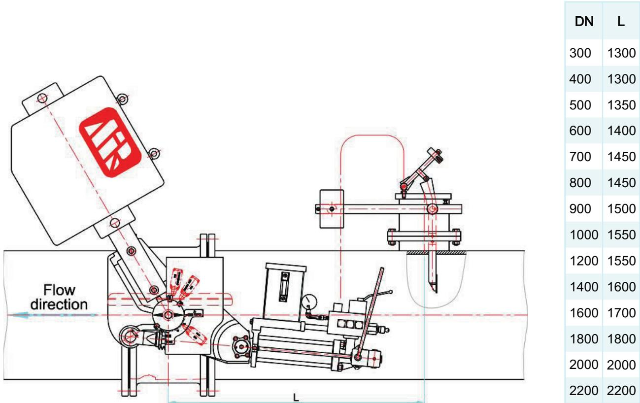
شکل ۲) با سیستم حسگر سرعت اختلاف فشار (Differential pressure sensor)
