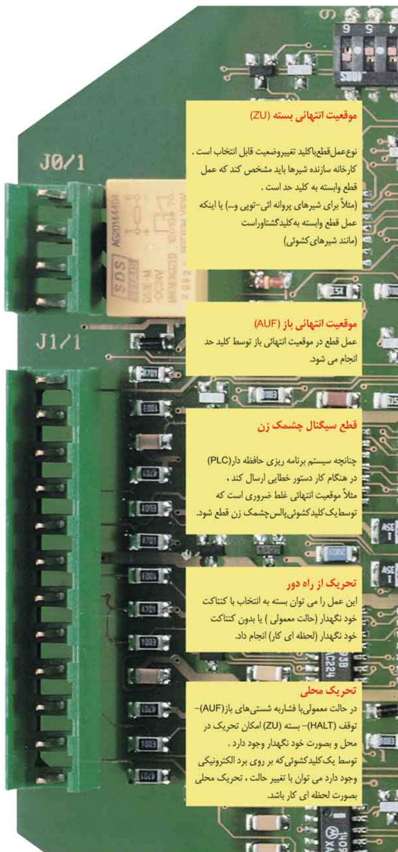
در حالت معمولی با فشاریه شیستی های باز (AUF)-توقف (HALT)-بسته (ZU) امکان تحریک در محل و بصورت خود نگهدار وجود دارد. توسط یک کلید کشوئی که بر روی برد الکترونیکی وجود دارد می توان با تغییر حالت، تحریک محلی بصورت لحظه ای کار باشد.
