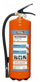
خاموش کننده ۶ کیلویی تحت فشار پودری مدل FX6 ساخت کمپانی TOTAL آلمان حاوی پودر نوع TOTALIT G آلمانی دارای گواهینامه بین المللی Wheelmark مناسب برای شرایط آب و هوایی مرطوب کاملا مقاوم دارای استاندارد EN3 قدرت خاموش کنندگی از نوع 43A/233B/C دمای کارکرد از ۳۰ ـ تا ۶۰ درجه سانتیگراد
