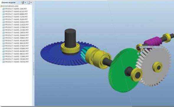
Dişli, mil, rulman ömrü gibi tüm mühendislik hesaplamaları güvenilirliği dünyaca kabul görmüş KISSsoft yazılımı ile yapılmaktadır. Redüktör içerisinde yer alan makine elmanlarının tek tek yapılan hesaplamalarının yanı sıra Kissys yazılımı kullanılarak redüktör bir bütün olarak modellenmekte ve komple sistem tasarımları yapılmaktadır.
