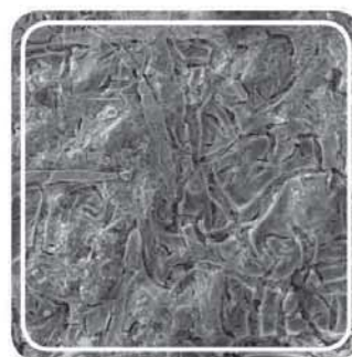
◀ ساختار میکروسکوپی پوشش آندهای MMO
