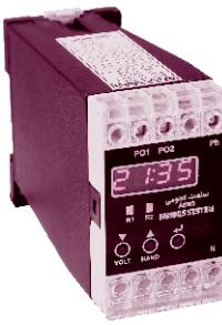
دارای ۲ خروجی مجزا میباشد که خروجی PO1 در زمان طلوع (همراه با مقدار افست تنظیم نسبت به طلوع) سیستم روشنایی راقطع و در زمان غروب (همراه با مقدار افست تنظیم نسبت به غروب) سیستم روشنایی را وصل می کند. خروجی PO2 دو ثانیه بعداز خروجی اول وصل شده و در ساعت دلخواه که توسط مصرف کننده تنظیم می شود، خاموش می گردد.
